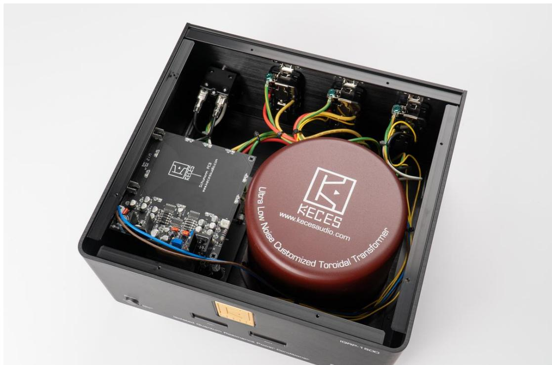
而一般常見的隔離變壓器多使用 EI 變壓器，一旦為求更高的 VA 輸出，變壓器就不得不做得很大，而這樣大的變壓器在通過大電流時，由矽鋼片疊合而成的鐵芯就容易有震動，且有電流哼聲。再加上 EI 變壓器可能有更高的漏磁，反而使得音響系統受到電磁波的干擾。這也是很多音響用家不喜歡使用隔離變壓器的原因。解決了一個問題，卻又衍生出其它更多的問題。
